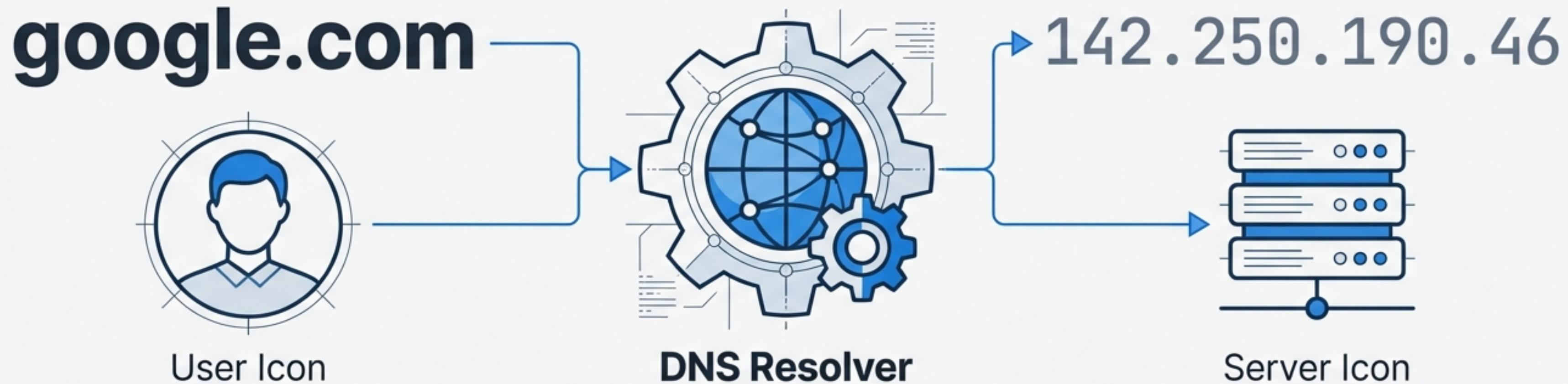
Internet no entiende 'google.com'; funciona con direcciones IP. Cuando la caché falla, el navegador pide ayuda al Resolver DNS.
